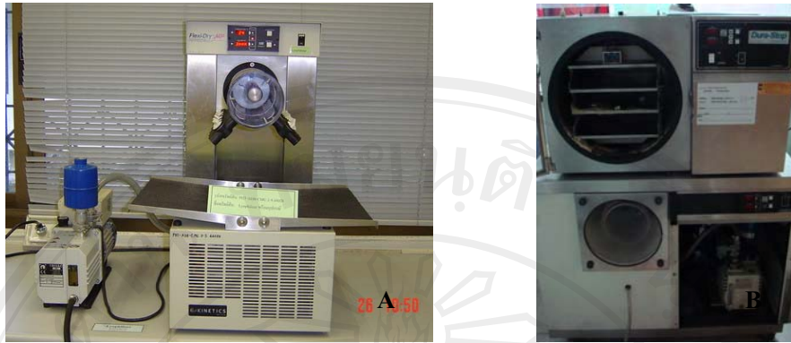
ภาพที่ 5 เครื่อง Lyophilizer รุ่น Flexi-Dry MP (A) ของศูนย์นวัตกรรมและเทคโนโลยี มหาวิทยาลัยเชียงใหม่ และเครื่อง Dura-Stop™ Stopping Tray Dryer (B) ของห้องปฏิบัติการกลาง คณะเกษตรศาสตร์ มหาวิทยาลัยเชียงใหม่ ที่ใช้ในการทำอาหารเทียมผง
