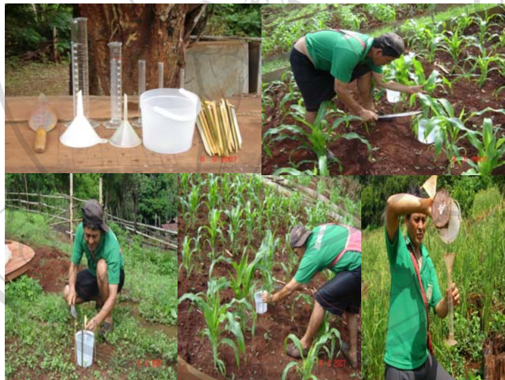
รูปที่ 3.7 แสดงอุปกรณ์ วิธีการติดตั้ง และการวัดปริมาณน้ำที่ค้างบนผิวใบพืชแล้วระเหยกลับสู่บรรยากาศ (Interception)
