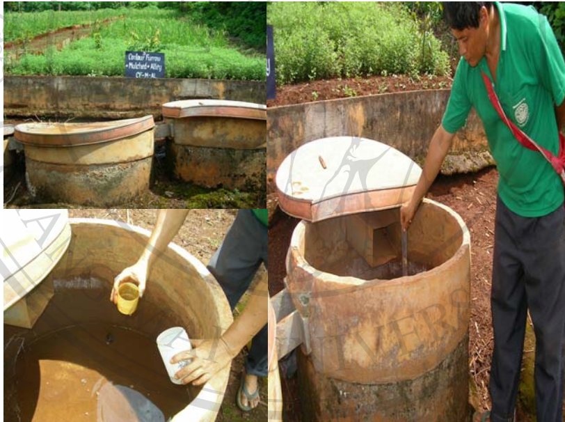
รูปที่ 3.6 แสดงการวัดปริมาณน้ำที่ไหลบ่าบนผิวดิน (Surface Runoff) ในถังดักตะกอน
