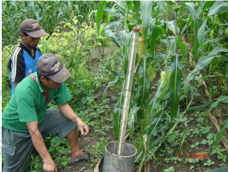
รูปที่ 3.4 แสดงการวัดอัตราการซึมน้ำเข้าสู่ผิวดิน (Infiltration Rate, IR) โดยใช้เครื่องมือสำเร็จรูป จานวัดการซึมน้ำของดิน (Disc Permeameter)
