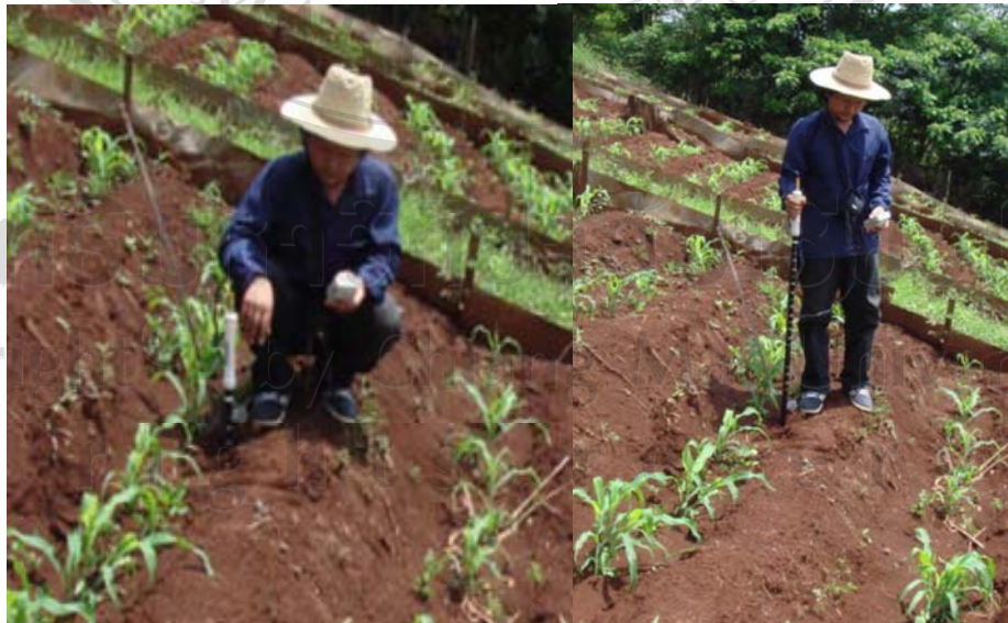
รูปที่ 3.5 แสดงการวัดการเปลี่ยนแปลงปริมาณการกักเก็บน้ำภายในดินโดยใช้เครื่องมือสำเร็จรูป Time Domain Reflectometry (TDR)
