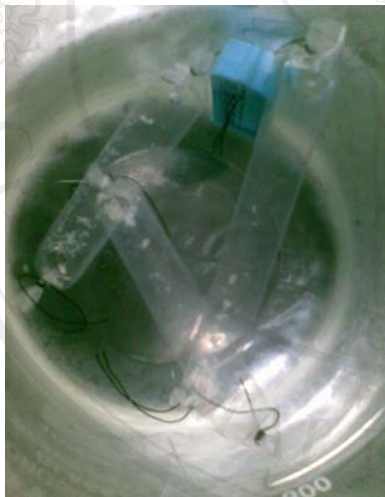
ภาพ 3-1 แสดงวิธีการการตกตะกอนโปรตีนในถุง dialyze ด้วย (\text{NH}_4)_2\text{SO}_4 ในน้ำกลั่น และวิธีการใช้ Hi Trap ® Protein G column ในขั้นตอนการทำแอนติบอดีให้บริสุทธิ์
