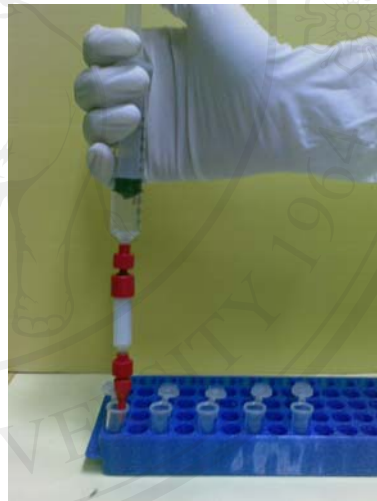
ภาพ 3-1 แสดงวิธีการการตกตะกอนโปรตีนในถุง dialyze ด้วย (\text{NH}_4)_2\text{SO}_4 ในน้ำกลั่น และวิธีการใช้ Hi Trap ® Protein G column ในขั้นตอนการทำแอนติบอดีให้บริสุทธิ์
