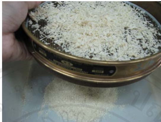
ภาพที่ 3-8. การล่อนขนอ้อยผ่านตะแกรงเบอร์ 16.
