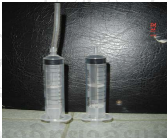
ภาพที่ 7 แสดงอุปกรณ์สำหรับการป้อนโยเกิร์ต โดยใช้ กระบอกฉีดยาต่อกับสายน้ำเกลือ
