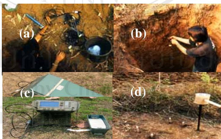
รูปที่ 3.4 (a), (b) แสดงวิธีการติดตั้งอุปกรณ์วัดความชื้นดิน (TDR) ที่เป็นแท่งแม่เหล็กโลหะนำคลื่น (wave guide) ตามความลึกดินระดับต่างๆ (c) เครื่องมือวัดปริมาณความชื้นดิน และ (d) แสดงการติดตั้งอุปกรณ์วัดแรงดึงความชื้นของดิน (Tensiometer)
