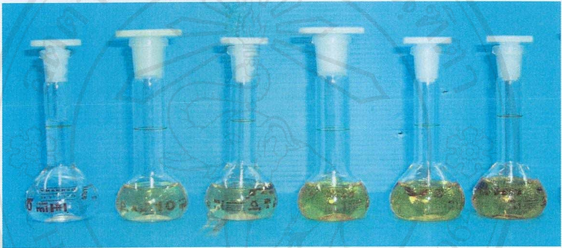
รูป 21 สารละลายไลโคปีนมาตรฐาน ที่ปรับความเข้มข้น 0 – 18 มิลลิกรัม/ลิตร
