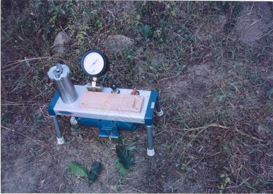
ภาพที่ 5 เครื่องวัดค่าสัมประสิทธิ์ของน้ำในใบ
