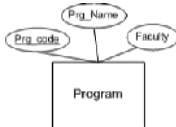
ภาพที่ 4.11 แสดงส่วนประกอบของเอนิตีโปรแกรมวิชา
