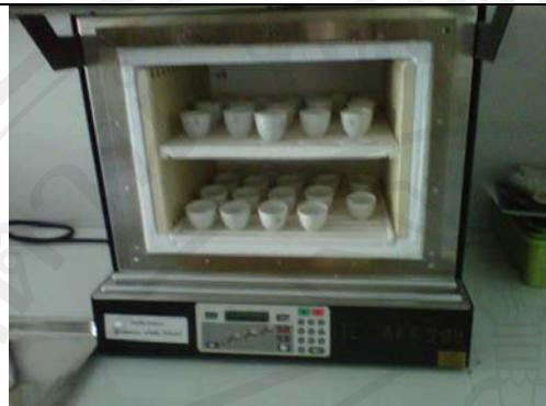
5. นำตัวอย่างเข้า Muffle furnace ที่ อุณหภูมิ 550 °C เป็นเวลา 3 ชั่วโมง (หรืออาจมากกว่า 3 ชั่วโมง ขึ้นอยู่กับชนิดของสาร ตัวอย่างที่จะเผาไหม้ได้สมบูรณ์) ทิ้งไว้เย็น นำตัวอย่างออกจากเตาแล้ว นำเข้า Dessicator เป็นเวลา 20 นาที
