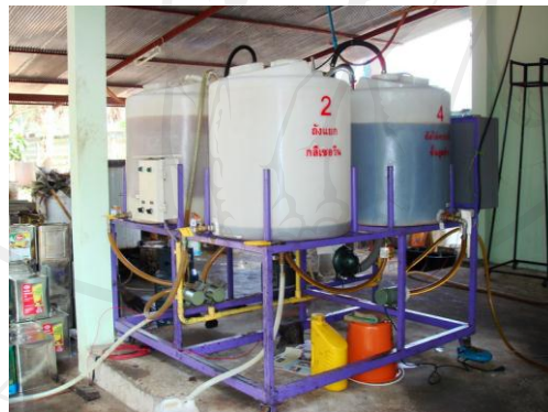
ภาพที่ 2.3 เครื่องผลิตไบโอดีเซล รุ่น CMU-2
