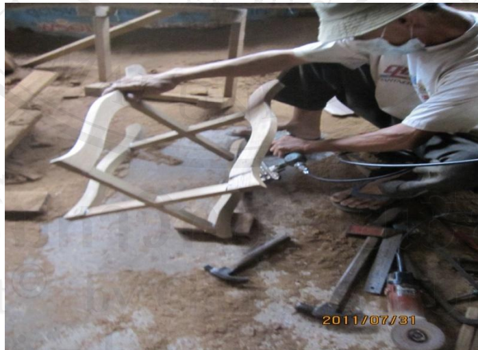
ภาพที่ 28 ประกอบขาโต๊ะกับไม้ยึดขาโต๊ะโดยใช้กาวลาเท็กซ์และเม็ทซ์
