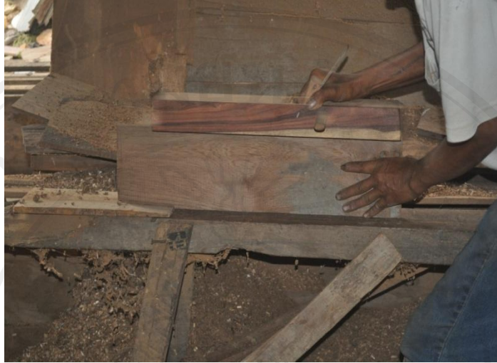
ภาพที่ 49 ไสขอบให้เรียบด้วยเต้าขัดผิวไม้ (เต้ามือ)
