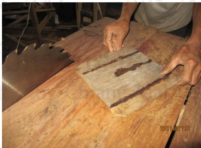
ภาพที่ 26 ตัดแผ่นไม้ตามแบบโดยใช้เลื่อยวงเดือน
