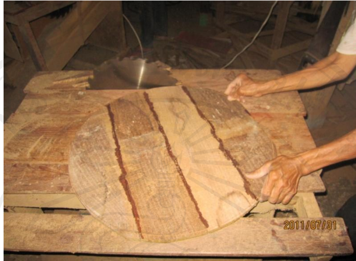
ภาพที่ 17 ตัดแผ่นไม้ให้เป็นวงกลมโดยใช้เลื่อยวงเดือน
