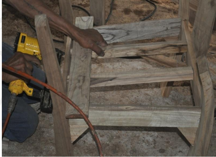
ภาพที่ 45 นำคานส่วนกลางเก้าอี้มาติดกับโครงสร้างโดยใช้ปืนลมยิงแม่เหล็กและตะปู
