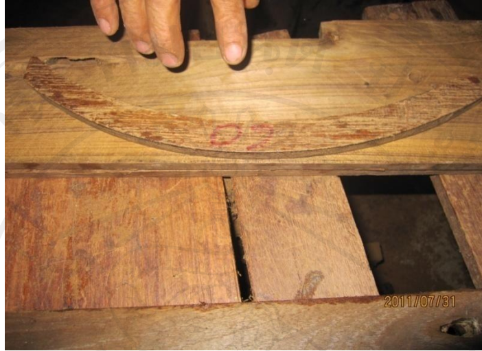
ภาพที่ 19 ร่างแบบขอบโต๊ะโดยใช้แบบร่าง
