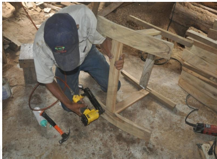
ภาพที่ 40 ประกอบโครงสร้างโดยใช้กาวลาเท็กซ์และปืนลมยิงแม่กซ์ยึดชิ้นงาน
