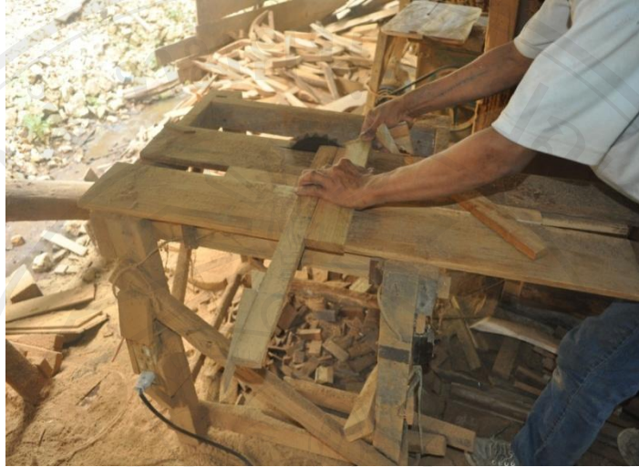
ภาพที่ 41 ตัดไม้สักทองให้เป็นรูปสามเหลี่ยมเสริมมุมคานทั้งสี่ด้าน
