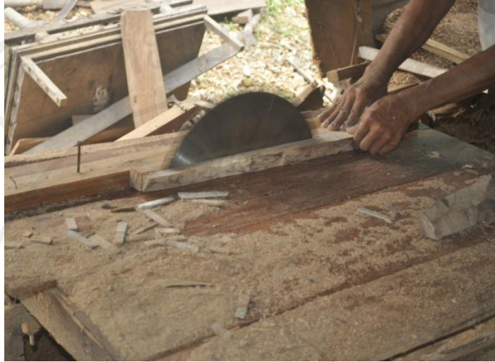
ภาพที่ 43 ซอยไม้สักทองทำคานรับน้ำหนักส่วนกลางเก้าอี้โดยใช้เลื่อยวงเดือนตัดให้ได้ขนาด
