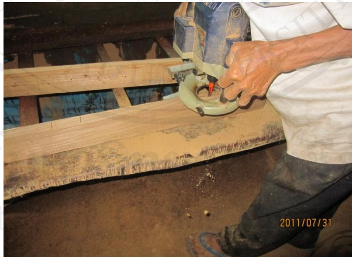
ภาพที่ 4 ไม้สักทองถูกเจาะด้วยเร้าเตอร์
