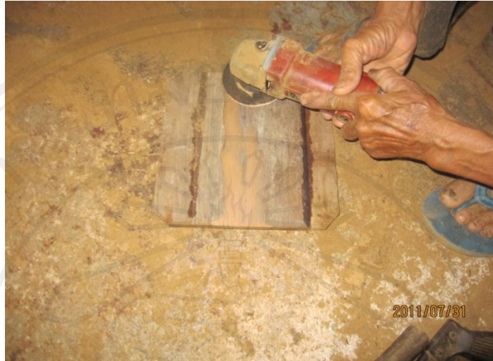
ภาพที่ 27 ขัดละเอียดแป้นโต๊ะส่วนล่างด้วยเครื่องขัดกระดาษทราย
