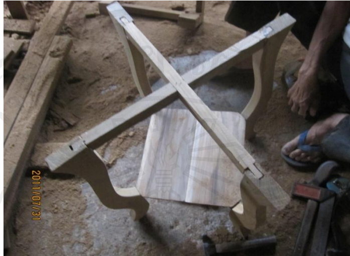
ภาพที่ 29 ยึดขาโต๊ะกับแป้นโต๊ะส่วนล่างด้วยแม่กซ์
