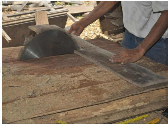
ภาพที่ 47 ตัดแผ่นไม้สักเก่าด้วยเลื่อยวงเดือน
