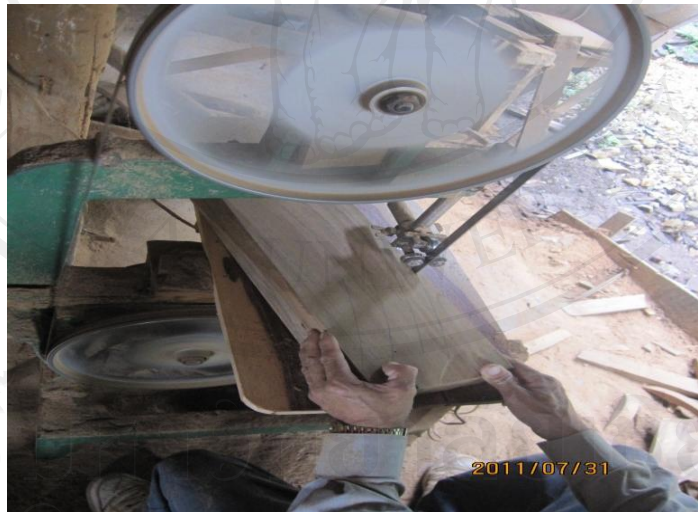
ภาพที่ 33 คลุตามแบบด้วยเลื่อยวงเดือน
