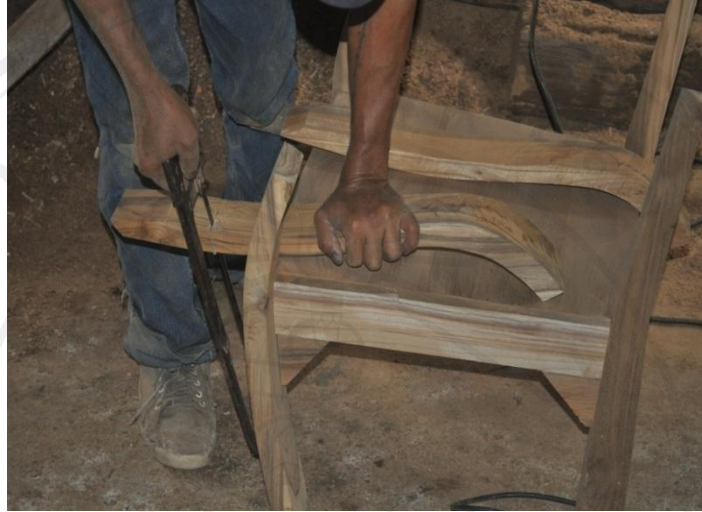
ภาพที่ 56 ตัดส่วนเกินของแขนเก้าอี้โดยใช้เลื่อยเล็ก
