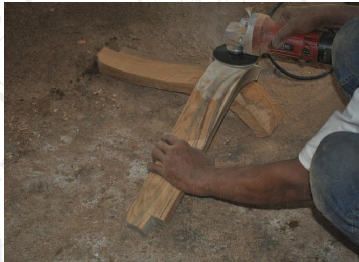
ภาพที่ 57 ขัดแขนเก้าอี้ด้วยเครื่องขัดกระดาษทราย
