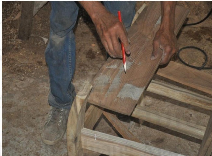
ภาพที่ 50 วัดขนาดของแผ่นไม้กับมุมของขาเก้าอี้ทั้งสองด้าน
