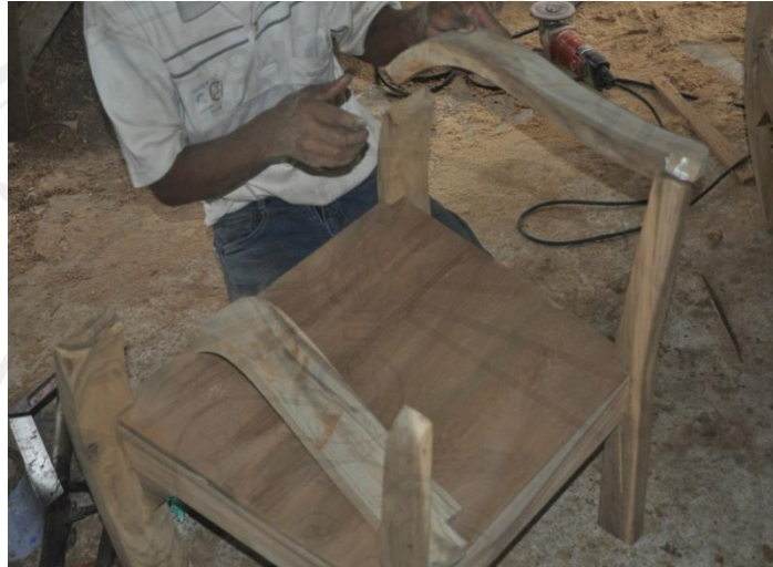
ภาพที่ 58 นำแขนเก้าอี้ติดกับโครงสร้างโดยใช้กาวลาเท็กซ์และปืนลมยิงเม็ทซ์
