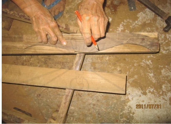
ภาพที่ 3 การนำไม้สักทองมาร่างแบบส่วนของขาโต๊ะ
