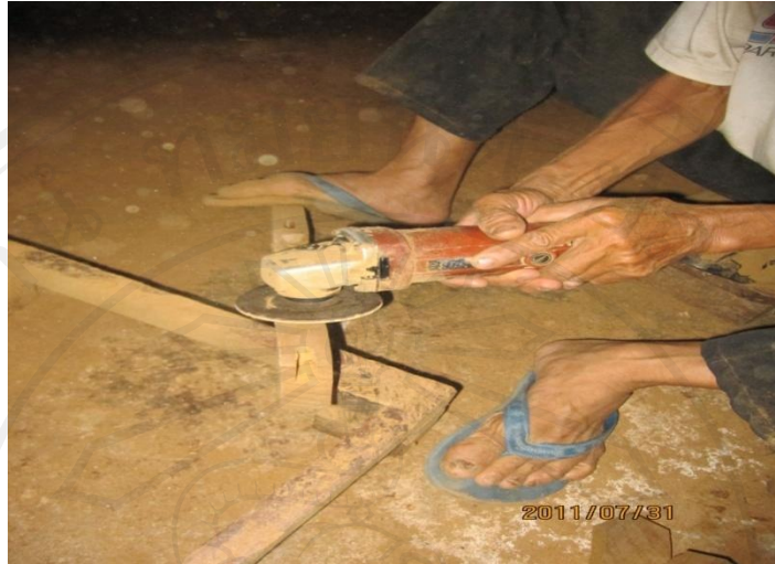
ภาพที่ 7 ไม้สักทองถูกขัดด้วยเครื่องขัดกระดาษทราย
