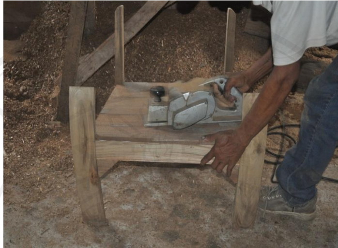
ภาพที่ 54 ชัดผิวไม้ให้เรียบด้วยเต่าขัดผิวไม้ (เต่าไฟฟ้า) และเครื่องขัดกระดาษทราย
