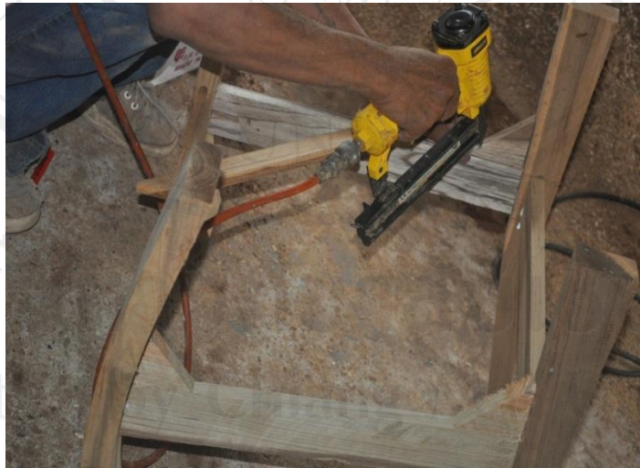
ภาพที่ 42 ติดมุมเสริมคานทั้งสี่ด้านยึดด้วยปืนลมยิงแม็กซ์
