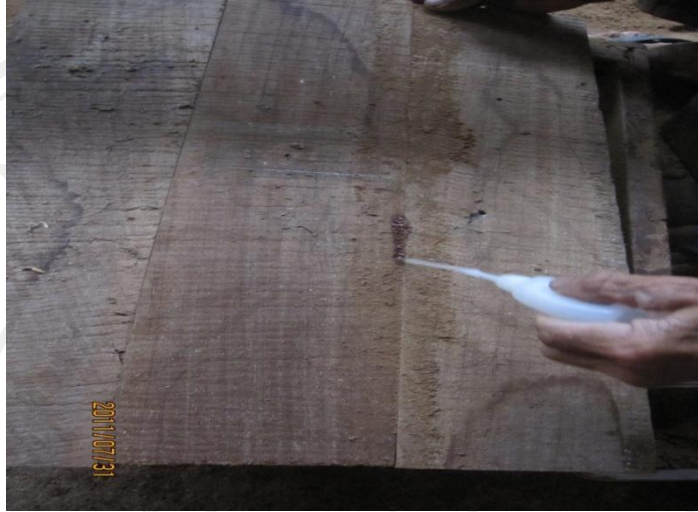
ภาพที่ 15 ประกอบแผ่นไม้สักเก่าให้เป็นแผ่นเดียวกันโดยใช้ผงขี้เถ้าอ่อนและกาวยร้อน
