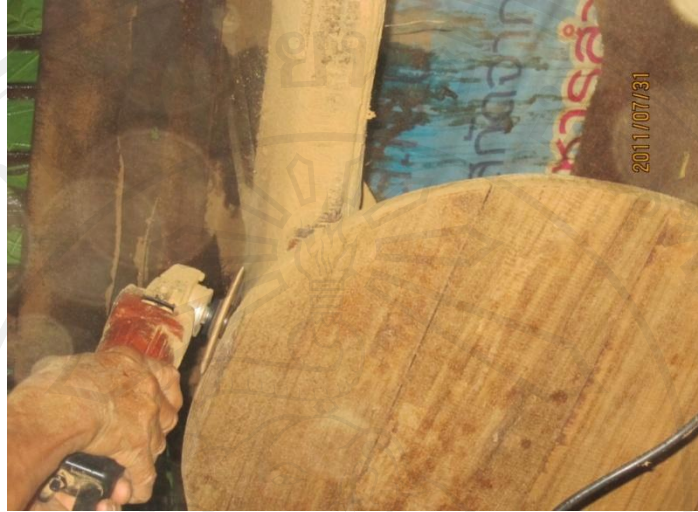
ภาพที่ 23 ขัดขอบแป้นโตะด้วยเครื่องขัดกระดาษทราย
