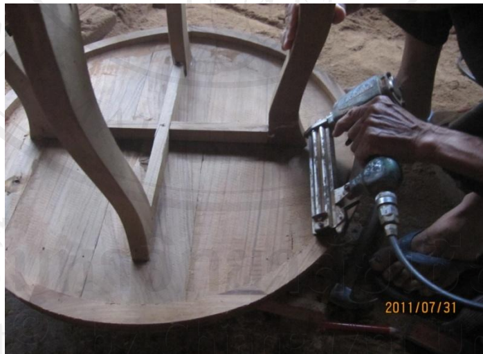
ภาพที่ 30 ยึดขาโต๊ะกับแป้นโต๊ะด้วยกาวลาเท็กซ์ สกรูเกลียวป้อยและสว่านเจาะนำศูนย์
