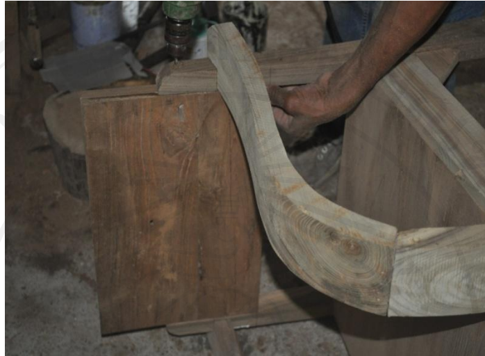
ภาพที่ 60 ตัดเป็นฟิงใช้ปืนลมยิงแม็กซ์ ส่วนเจาะนำศูนย์และส่วนอัดสกรูเกลียวปล่อยยึดชิ้นงาน
