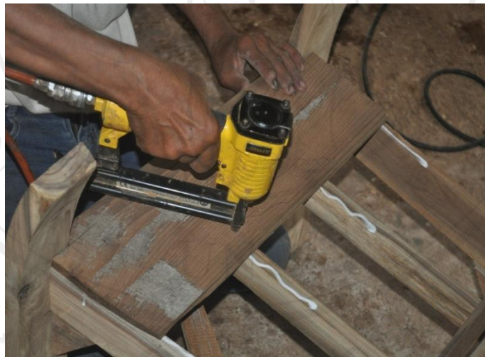
ภาพที่ 53 ประกอบแป้งเก้าอี้เข้ากับโครงสร้างโดยใช้กาวลาเท็กซ์และปืนลมยิงเม็กซ์
