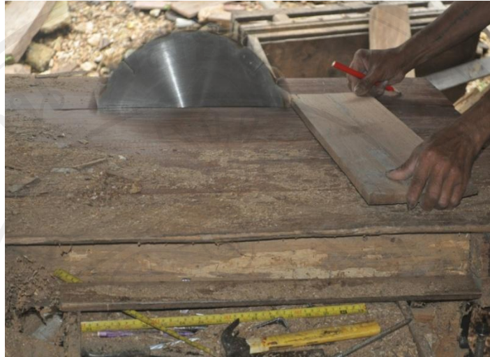
ภาพที่ 51 ตัดมุมแผ่นไม้ด้วยเลื่อยวงเดือนเพื่อใช้ประกอบเป็นแผ่นนั่ง
