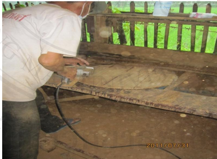
ภาพที่ 18 ไสเป็นโต๊ะโดยใช้เต่าขัดผิวไม้ไฟฟ้า
