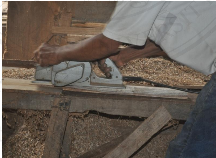
ภาพที่ 44 นำไม้สักทองที่ซอยเสร็จนำมาไสให้เรียบด้วยเต่าขัดผัดไม้ (เต่าไฟฟ้า)
