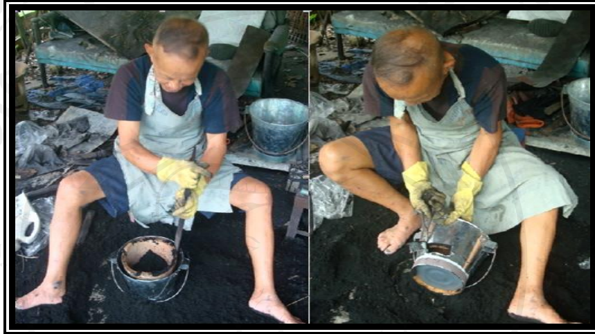
ภาพที่ 26 ประกอบเตาอังโล่ประหยัดพลังงานกับถังสังกะสีและตัดตกแต่ง ที่มา : กุลธิดา คมะณี,2553 : ถ่ายด้วยตนเอง
