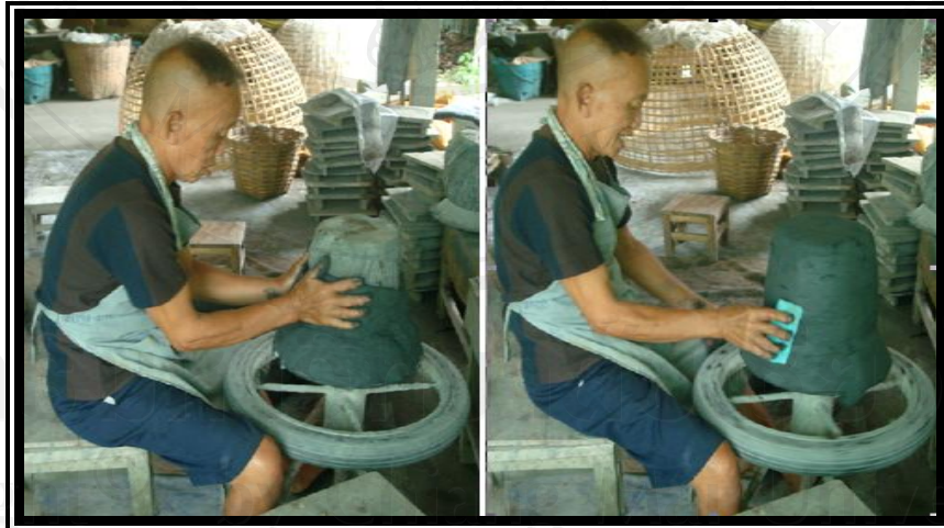
ภาพที่ 22 ขั้นตอนการขึ้นแบบเตาอั้งโล่ประหยัดพลังงาน ที่มา : กุลธิดา คมะณี,2553 : ถ่ายด้วยตนเอง
