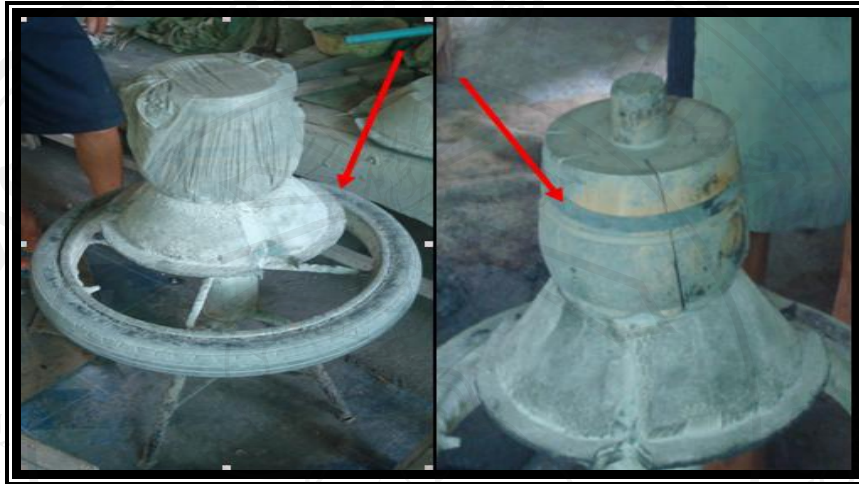
ภาพที่ 9 แท่นปั่นและแบบปั่นเตาอั้งโล่ประหยัดพลังงาน
