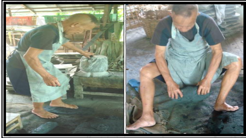
ภาพที่ 20 ขั้นตอนการย่ำดินและนวดดิน ที่มา : กุลธิดา คมะณี, 2553 : ถ่ายด้วยตนเอง
