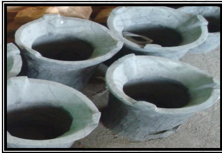
ภาพที่ 23 เตาอังโล่ประหยัดพลังงานที่ถูกตกแต่งเสร็จแล้ว ที่มา : กุลธิดา คมะณี,2553 : ถ่ายด้วยตนเอง
